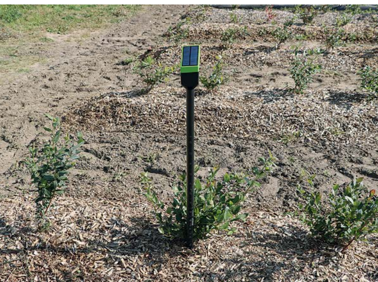
Fot. 5. Urządzenie Agreus do mierzenia wilgotności i zasolenia w glebie na kilku głębokościach
