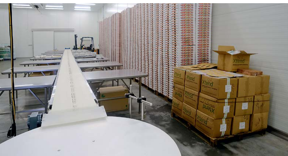
Fot. 11. Hala do sortowania ze stołami, na których znajdują się stanowiska do ważenia i konfekcjonowania owoców
