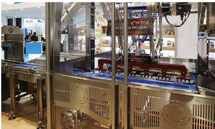
Fot. 9. Robot układający jednostkowe pojemniki w opakowaniach zbiorczych
