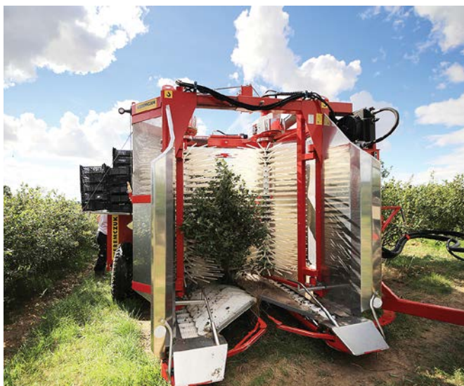
Fot. 3. Karen to catorzędowa, zaczepiana do ciągnika maszyna, wyposażona w parę pionowych otrząsaczy z plastikowymi palcami
