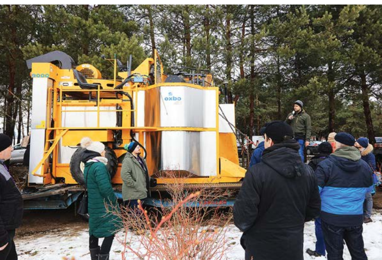
Fot. 5. Kombajn Oxbo 9000 to samojezdna maszyna obsługiwana przez 4 osoby, wyposażona w dwie taśmy rewizyjne
