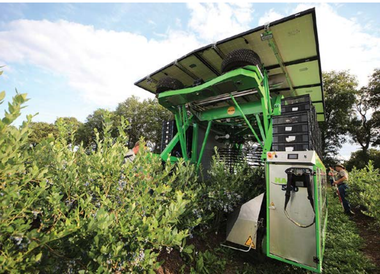
Fot. 1. Harvy500 to samojezdna maszyna zasilana ogniwami fotowoltaicznymi zamontowanymi na dachu fot. 1, 3-5 M. Podymniak
