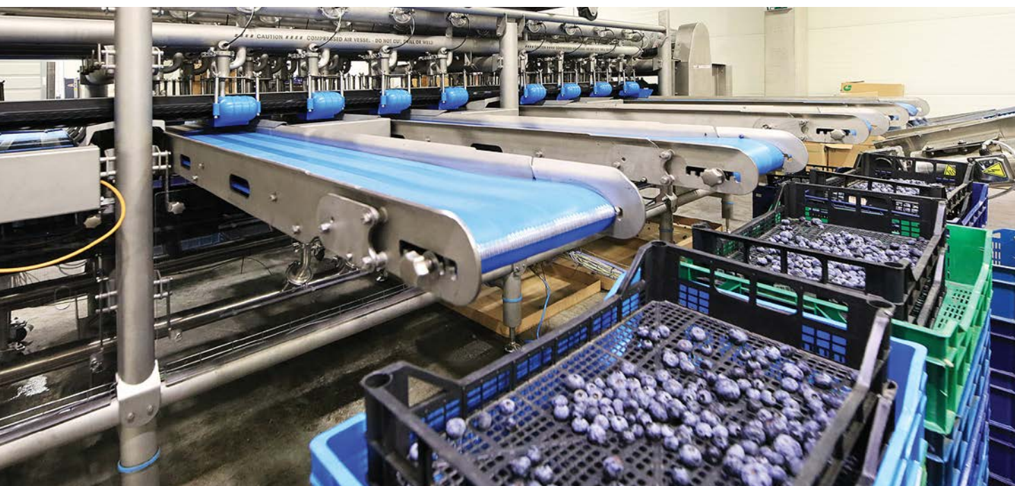
Fot. 8. Za pomocą precyzyjnych sorterów można dokładnie oddzielić owoce niespełniające określonych norm jakościowych
