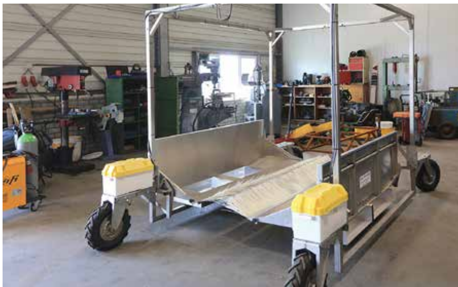
Fot. 1. Jedna z pierwszych maszyn do zbioru borówek, skonstruowana przez późniejszych założycieli firmy FineField
