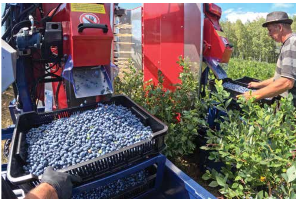
Fot. 7. Na tylnej platformie przygotowano dwa stanowiska dla osób odbierających skrzynki z owocami
