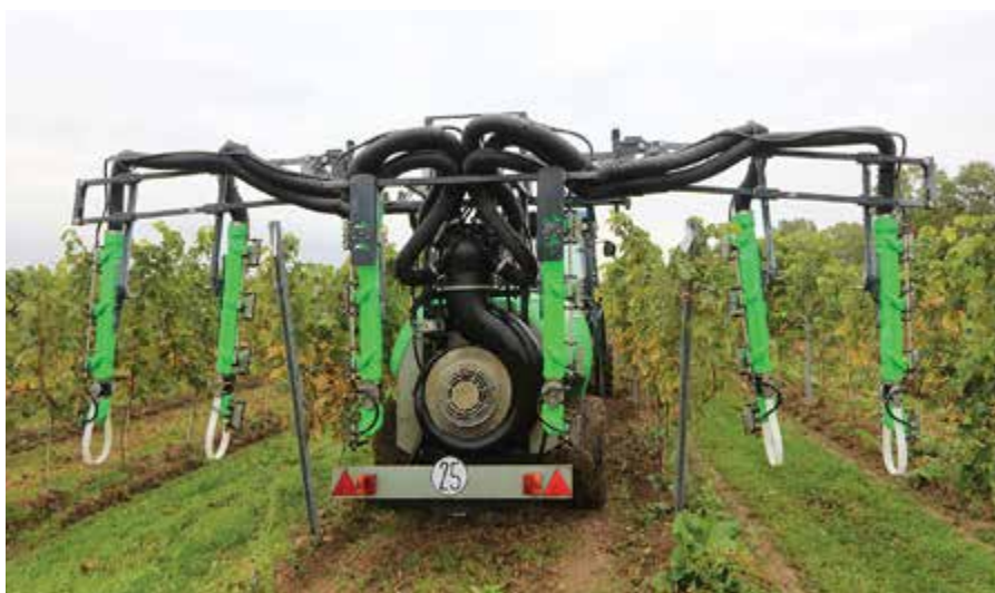
Fot. 3. Opryskiwacz przeznaczony do zabiegu jednocześnie w 3 rzędach roślin podczas prezentacji w winnicy
