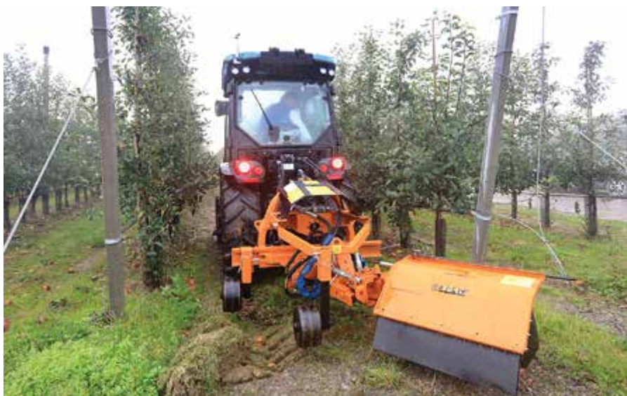
Fot. 2. Urządzenie do mechanicznego zwalczania chwastów podczas pracy w sadzie
