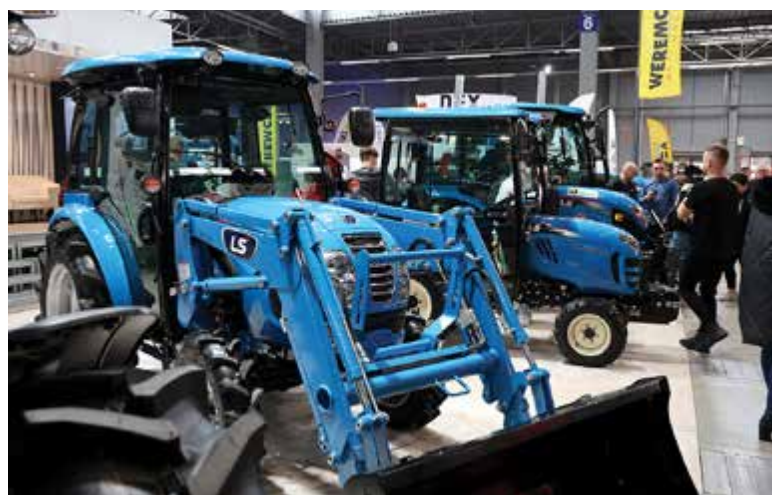
Fot. 2. Ładowacz czołowy LL3106 może być zamontowany na ciągnikach LS Tractor MT3.35 i MT3.40
