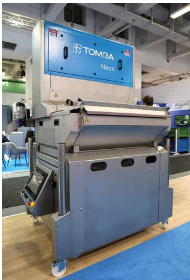
Fot. 7. Maszyna Tomra Neon służy do wstępnego sortowania borówek pochodzących ze zbioru mechanicznego...
